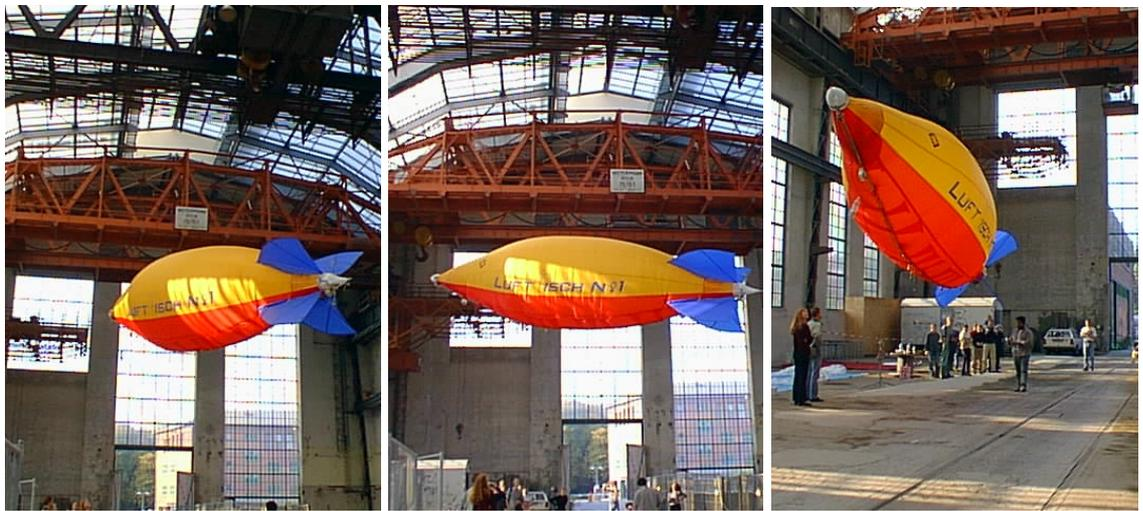
Abbildung 4: Drehversuch zur Untersuchung der Schubvektorsteuerung
